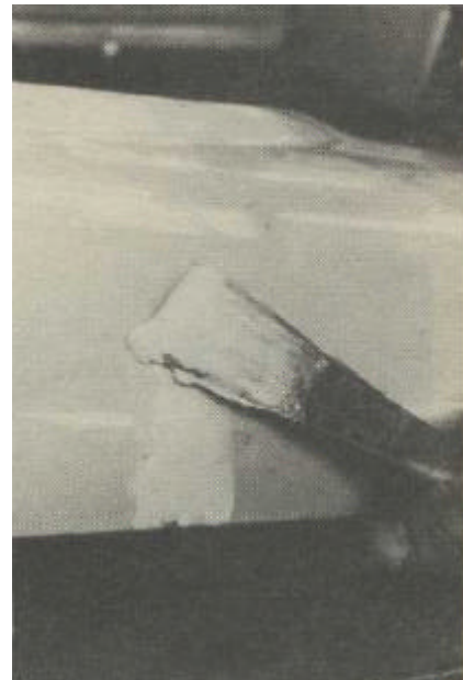
Bild 8 Ausfüllen der Ausfräsung auf der Vorderseite
