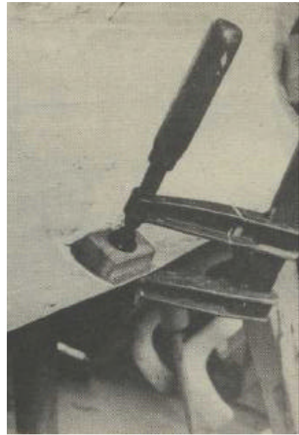
Bild 6 Verspannen von Duroplastteil und Metallstreifen
